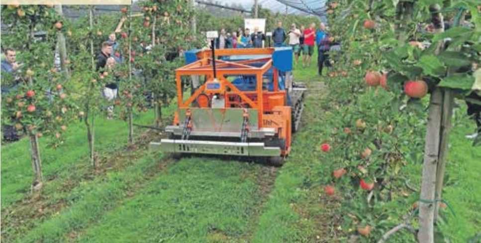
Slopehelper na avtonomni vožnji v sadovnjaku ob mulčenju trave FOTOGRAFIJE: TOMAŽ POJE
